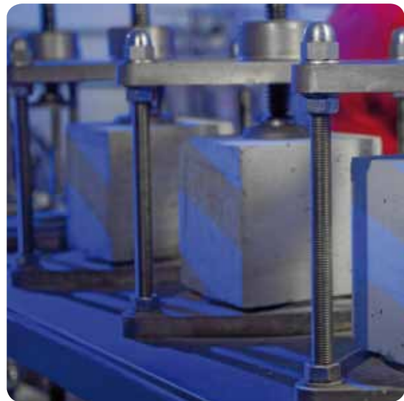
Prüfung der Wassereindringtiefe
