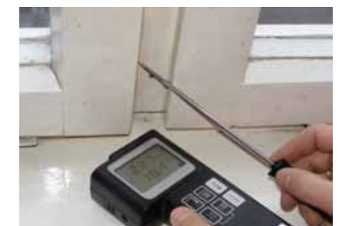
Prüfung auf Luftgeschwindigkeit, Thermoanemometer
