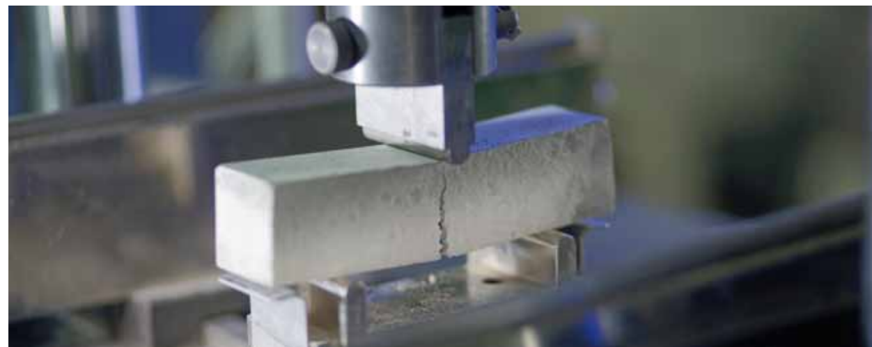
Bestimmung der Biegezugfestigkeit an Prismen
